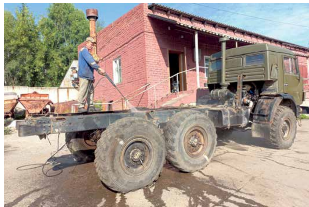
А это КАМАЗ-4310, восстановлением которого больше месяца занимались специалисты базы «Иркутскавтодора» на улице Варламова. На тяжеловесе пришлось заменить очень много: компрессоры, насосы, генератор, стартер. Сейчас машина практически готова, осталось «навести красоту», то есть покрасить. Подготовку к этому процессу вы видите на снимке: перед покраской автомобиль моют, сушат, где необходимо — шпаклюют и потом наносят краску
