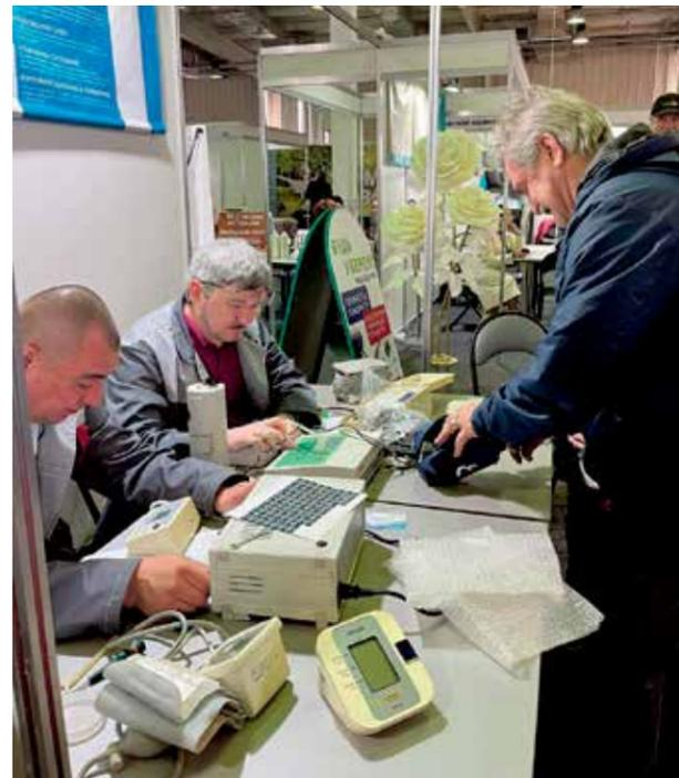
Все принесенные на проверку тонометры инженеры-метрологи подключали к эталонной установке и определяли, годны ли приборы измерения артериального давления к использованию или нет, не превышает ли погрешность максимально допустимую. Если тонометр показывает неверные цифры, самодиагностика для человека, страдающего сердечно-сосудистыми заболеваниями, будет затруднена
