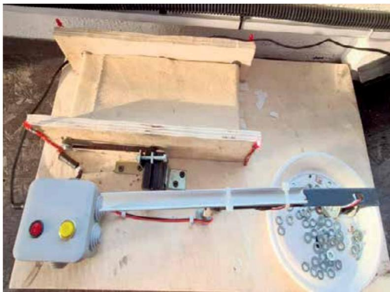
После того как посмотрел мультфильм «История игрушек — 3», Оскар попросил папу помочь сделать ему модель сортировки мусора. Это подвесной сепаратор с электромагнитом, извлекающий из мусора, движущегося по конвейеру, металл. Модель работает. Оскар продемонстрировал ее на конкурсе проектов для учащихся начальных классов
