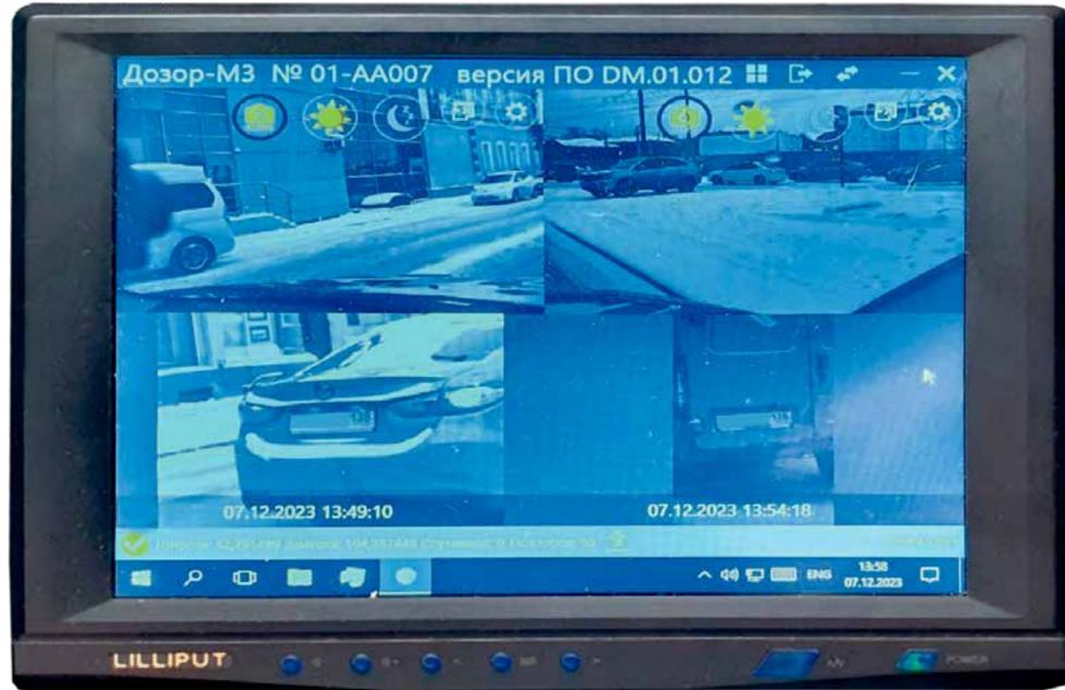
Этот монитор комплекса «Дозор-М3» установлен в автомобиле, который ежедневно курсирует по Иркутску. На экране — четыре окна: в двух верхних отображается обстановка на дороге, в двух нижних — последние из зафиксированных нарушителей. Прямо из автомобиля информация отправляется в Центр автоматизированной фиксации административных правонарушений, а оттуда, после обработки информации специалистами, штрафы отправляются владельцам автомобилей
