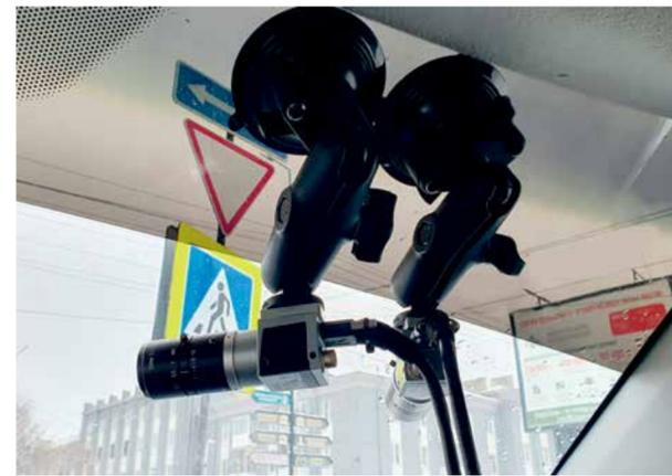
Так выглядят камеры комплекса «Дозор-М3» — они установлены на лобовом стекле и направлены на обочины дорог. При одностороннем движении устройство способно считывать нарушения сразу с обеих сторон проезжей части
