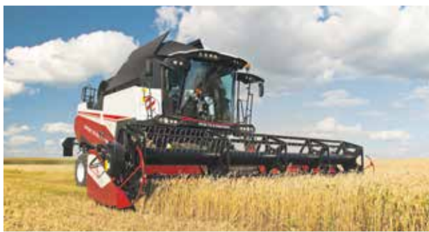
Зерноуборочная машина RSM 161 предназначена для уборки всех традиционных зерновых культур
