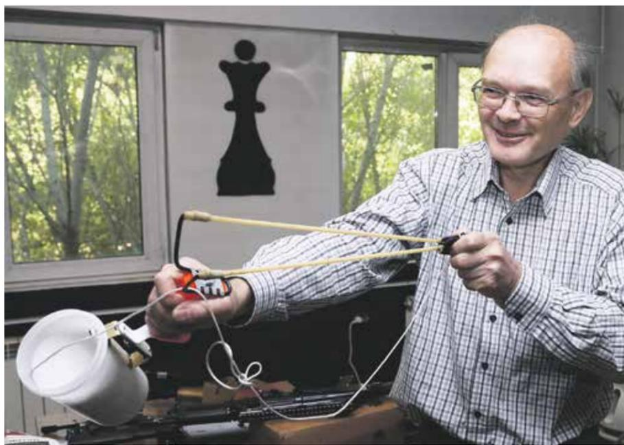
Этот линемет создан на основе «оружия», популярного в детстве изобретателя, — обычной рогатки. Но есть и более серьезное изобретение — саперный линемет для АК-74. Выстрелом холостого патрона небольшую «кошку» забрасывают на расстояние до ста метров, затем тянут ее обратно за лить, собирая таким образом все растяжки и обеспечивая безопасный проход группы
