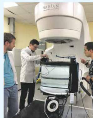
На фото — процесс установки референтного детектора в водный фантом
