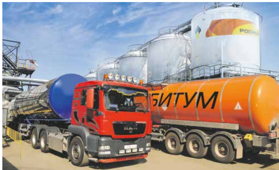
Битумное производство АНХК способно вырабатывать более 50 тонн нефтештукатурки в час. Отгрузка продукции осуществляется железнодорожным и автомобильным транспортом (на фото)
