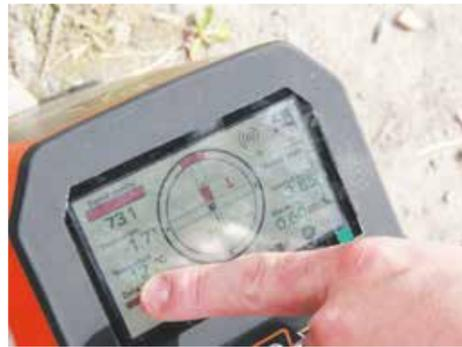
Еще один прибор, без которого невозможна технология ГНБ — система подземной локализации. Она регистрирует рабочие параметры процесса: угол и направление бурения, температуру рабочей зоны, обороты бура и так далее. Здесь, например, можно увидеть, что бур находится на глубине 3,85 метра, а процент изгиба штанги находится на отметке минус 1,7. Прибор также может показывать, где под землей находятся коммуникации. И это позволяет до начала бурения «просмотреть» трассу и заранее исключить помехи
