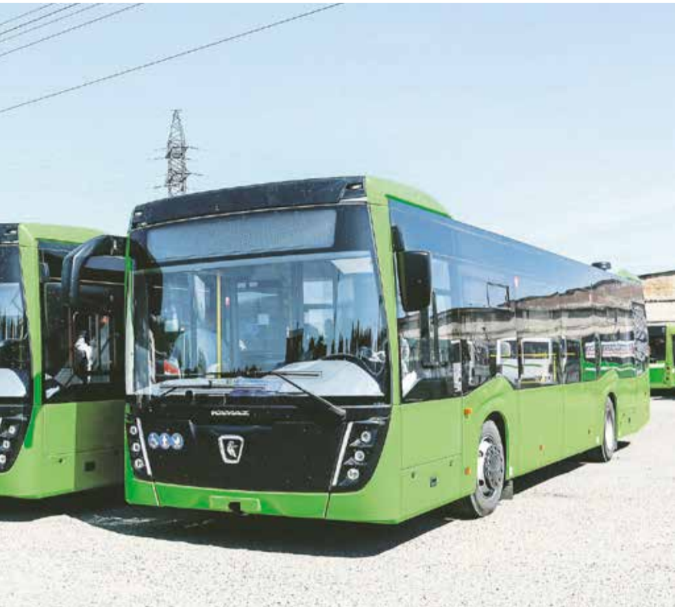
Автобусов дизельный двигатель мощностью 250 л. с., шестиступенчатая АКП, гидравлическими телескопическими амортизаторами, задний порталый мост с гидравлическими амортизаторами, рулевое управление с гидроусилителем, 4-контактный ABS, ASR. И для тех, кому просто ехать: в автобусе 29 посадочных мест плюс
