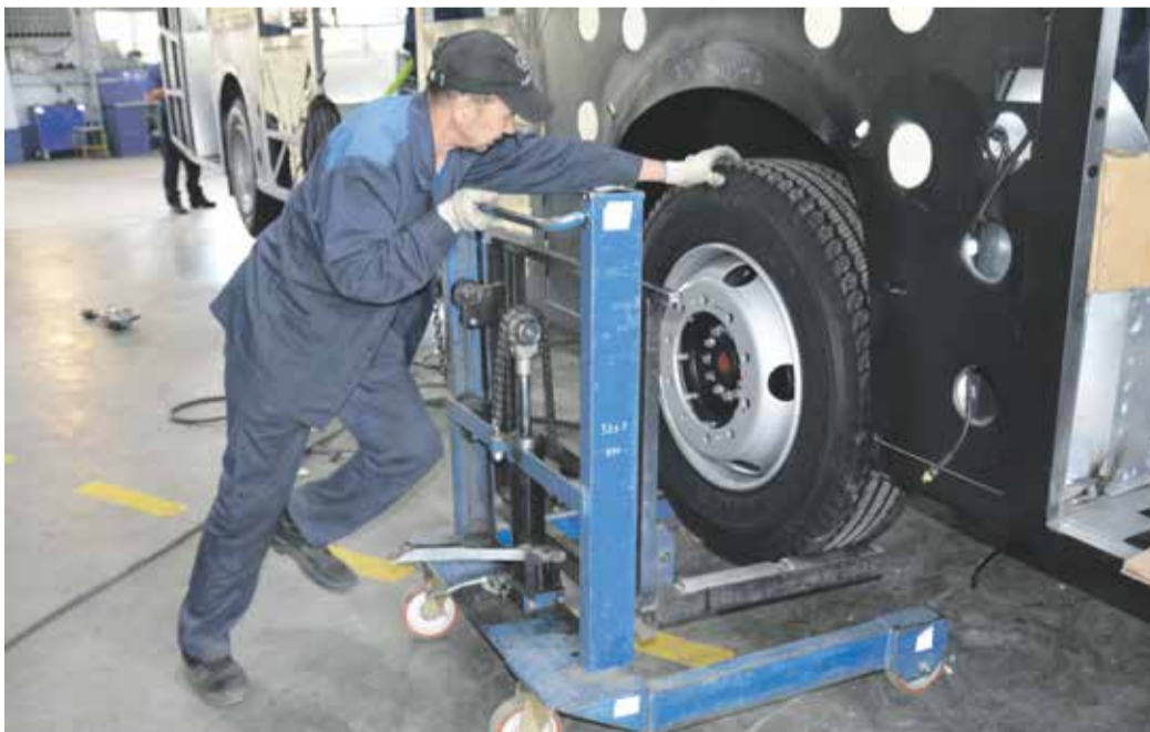
Виктор Байдуганов, слесарь механосборочных работ в цехе сборки автобусных шасси № 29, производит установку колес. Кстати, именно с шасси начинается первый шаг в создании нового автобуса: в сборочно-сварочном цехе № 22 сначала сваривается каркас основания автобусного шасси. И уже следом одновременно варят каркасы боковин автобуса: правую, левую, переднюю и заднюю — на специальных стандах, что обеспечивает точные геометрические параметры размеров и облегчает последующую сборку автобуса
