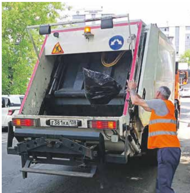
Новые мусоровозы с задней загрузкой работают на базе КамАЗа. Перед этим дворники собирают (метут улицы, тротуары, газоны, очищают урны) мусор в мешки и ставят их рядом с проезжей частью, а грузчики уже закидывают пакеты в ковш мусоровоза. Внутри машины все мешки трамбуются, освобождая тем самым много места. Благодаря этому мусоровоз может работать в круглосуточном режиме, не теряя времени на разгрузку
