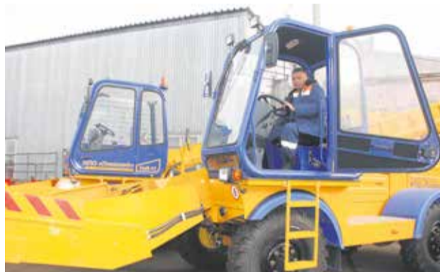
Водитель снегопогрузчика Владимир Корнаков с гордостью демонстрирует возможности новой машины. Объясняет, что такой снегопогрузчик называют «лаповым» и он наполняет самосвал за две-три минуты. То есть в десять раз быстрее, чем старая техника
