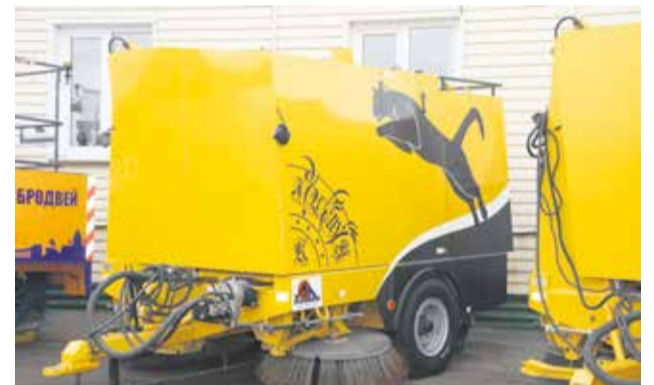
Помимо зимней техники приобрели еще летнюю коммунальную, в частности, две тракторные «Пумы». Это такой большой «моющий пылесос» с щетками, системой орошения и баком на 1150 литров: как раз хватит, чтобы помыть всю улицу Байкальскую за один проход
