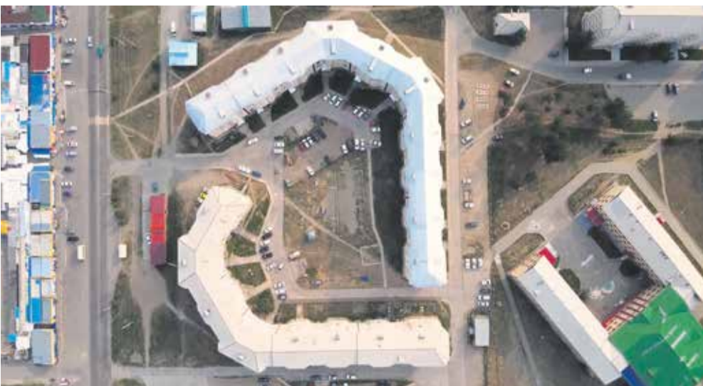
Первое, что бросается в глаза в Северобайкальске, — это ломаная форма домов. Мы узнали две причины такого архитектурного решения: для большей устойчивости во время землетрясений (а они тут не редкость) и чтобы ветра не задували во дворы
