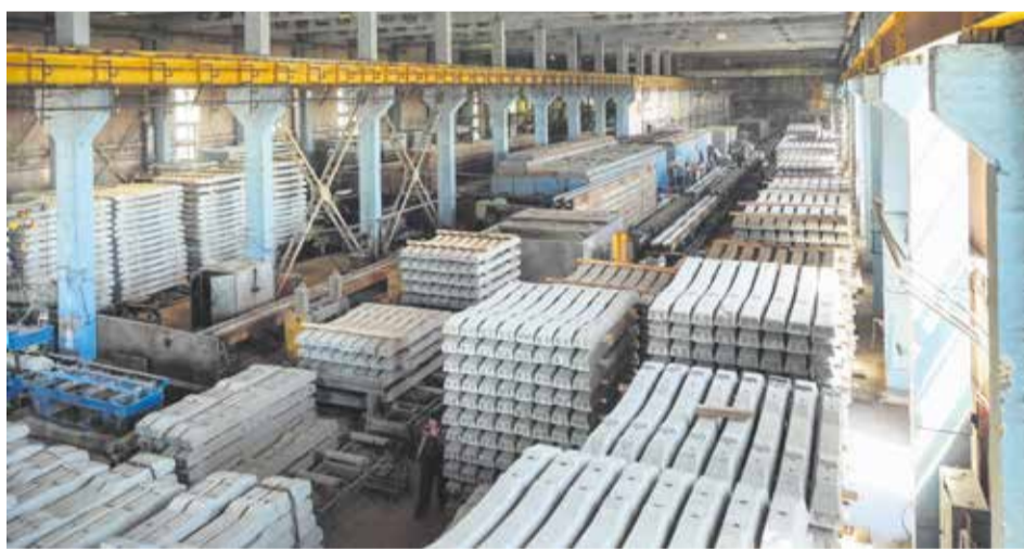
За одну смену с заводской линии иркутского ЖБК выходит тысяча готовых шпал, которые отправляются в разные концы страны, где строят и реконструируют железнодорожные пути
