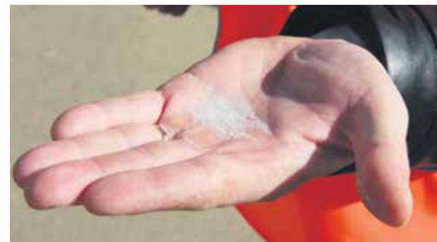
Это микростеклошарики. Их посыпают поверх холодного пластика, которым рисуют «зебру», чтобы полосы хорошо было видно в ночное время при свете фар. Они совершенно безвредны для автомобилей
