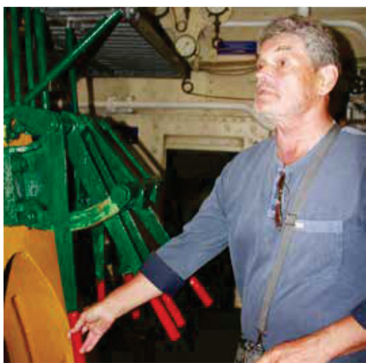
Константин Пашков показывает, как при помощи этих ручек механик подавал пар в цилиндры
