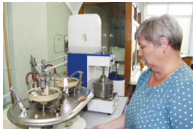
на правах рекламы Доцент Елена Кузнецова показывает работу прибора для отмычки клейковины зерна
