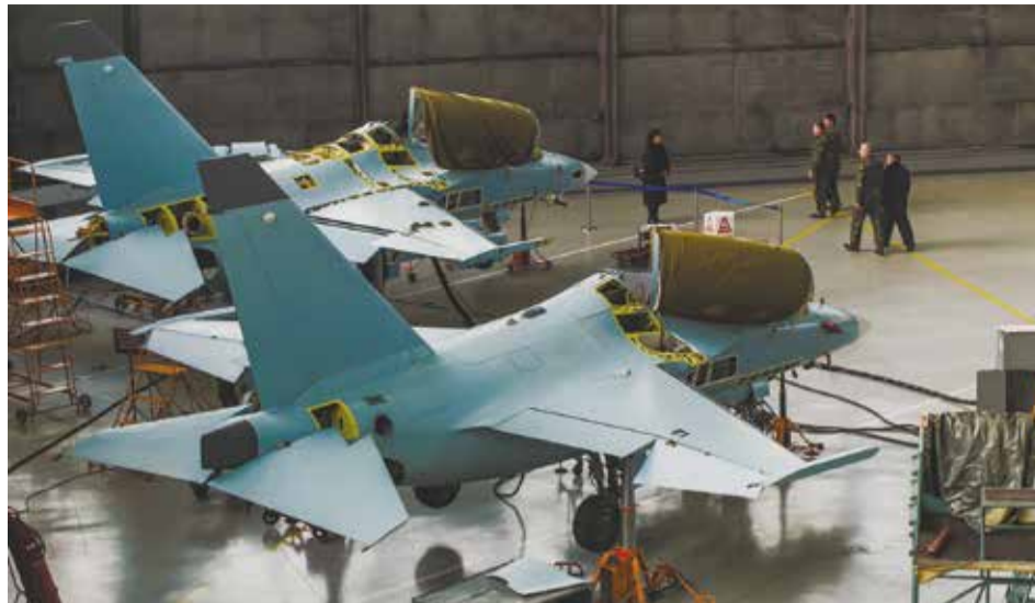
Учебно-боевой самолет Як-130, серийно производимый на ИАЗ, имеет почти 10-метровый размах крыла и весит более 7 тонн
