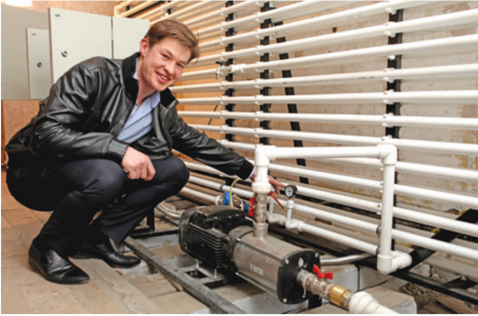
В лаборатории Дмитрия Киргина создан опытный образец, 300-метровая трубопровод с датчиками давления и вентилями
