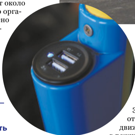
Новые современные троллейбусы оснащены обогревателями салона и эргономичными сиденьями, системой видеонаблюдения и USB-зарядки гаджетов
