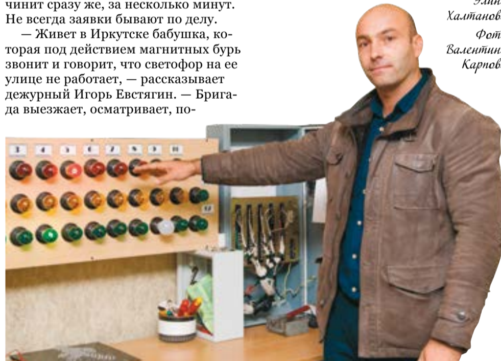
Сергей Шимков показывает ремонтный стенд, на котором отработывают программы, устанавливаемые на объектах
