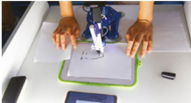
Робот-художник имеет три режима работы. Маркер можно заменить на лазер или руку-манипулятор
