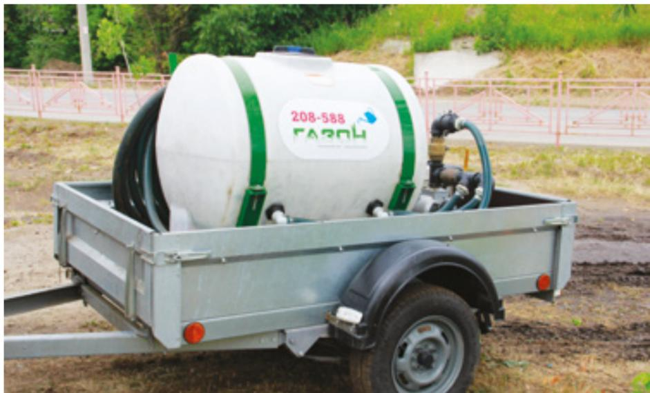
Внутри бака смешиваются компоненты, а потом добавляется вода. Такую бочку используют в местах, где не может проехать большая установка
