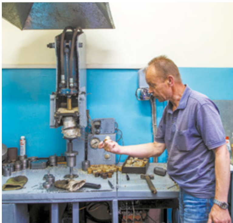
Станок для литья пластмассовых втулок — первое изобретение Огнева, которое и принесло ему определенную славу. На этом самодельном оборудовании до сих пор выпускаются «румяные» пластмассовые втулки
