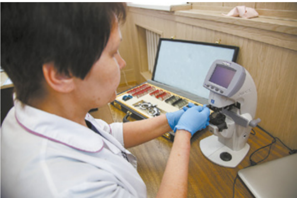
Инженер по метрологии Любовь Тигунцева за поверкой набора очковых линз
