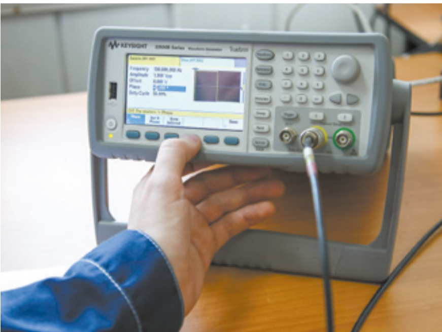
Генератор сигнала, который используется при поверке тахографов
