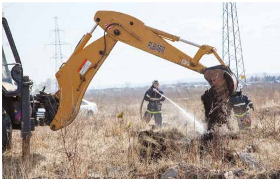
Люди и техника тушат торфяники в тандеме. Фронтальный погрузчик перемешивает землю, а пожарные проливают ее
