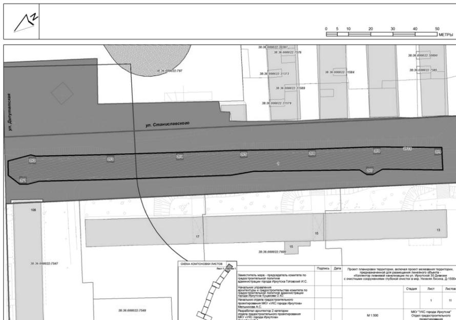
ПРОЕКТ ПЛАНИРОВКИ ТЕРРИТОРИИ, ВКЛЮЧАЯ ПРОЕКТ МЕЖЕВАНИЯ ТЕРРИТОРИИ, ПРЕДНАЗНАЧЕННОЙ ДЛЯ РАЗМЕЩЕНИЯ ЛИНЕЙНОГО ОБЪЕКТА — «КОЛЛЕКТОР ЛИВНЕВОЙ КАНАЛИЗАЦИИ ПО УЛ. ИРКУТСКОЙ 30 ДИВИЗИИ С ОЧИСТНЫМИ СООРУЖЕНИЯМИ ГЛУБОКОЙ ОЧИСТКИ В МКР. НИЖНЯЯ ЛИСИХА, Д-1500» ЧЕРТЕЖ МЕЖЕВАНИЯ ТЕРРИТОРИИ
