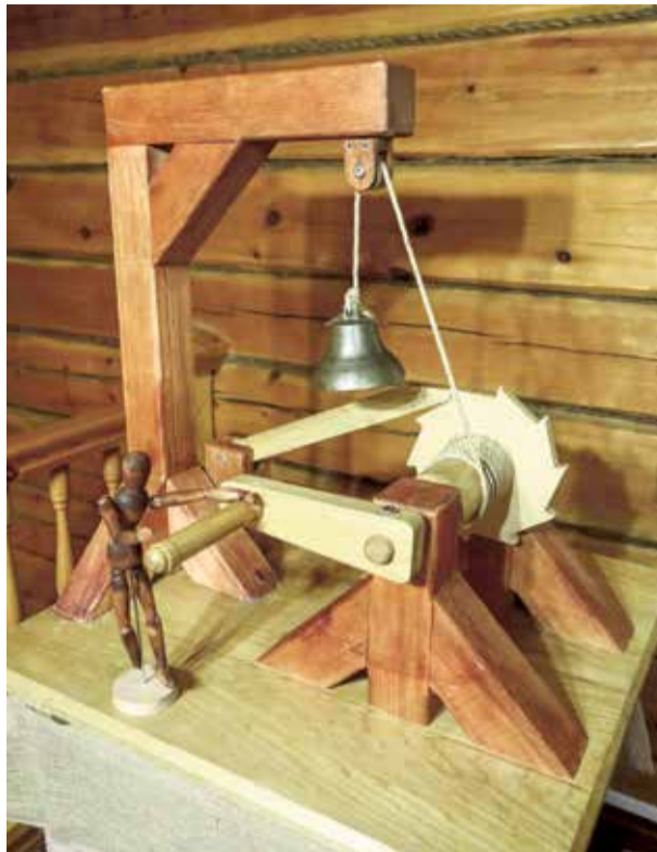
Макет на фото слева демонстрирует возможности червячной передачи при подъеме тяжестей. Впервые этот механизм упоминается еще в письменах древних египтян. Однако Леонардо да Винчи усовершенствовал данную технику. Устройство функционирует за счет зацепления зубьев червячного колеса и винта. Когда колесо останавливается, шестерни не могут вращаться и фиксируют груз на определенной высоте. На фото справа то же самое действие производится при помощи другого устройства, разработанного да Винчи. На снимке видно, как предмет фиксируется на высоте за счет зубчатого механизма. Среди аналогичных изобретений у Леонардо да Винчи есть машина для поднятия колонн, поворотный подъемный кран, молоточный подъемник. По сути, принцип работы этих механизмов до сих пор используется в лебедках, домкратах и подъемных кранах
