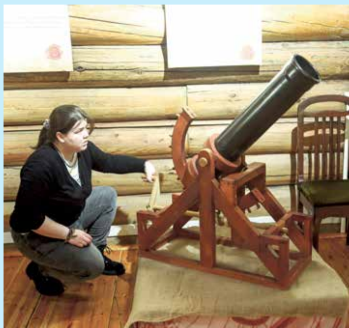
Научный сотрудник музея Дарья Рудакова продемонстрировала принцип работы устройства, с помощью которого можно изменить направление выстрела из пушки
