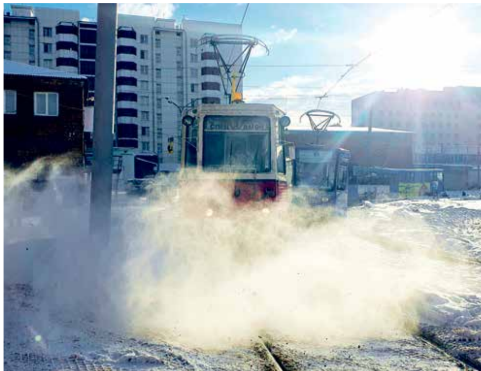
Вот он — вихревой снегоочиститель в действии! Облако снега вокруг спецвагона в лучах солнца выглядит очень красиво. Впрочем, увидеть подобную картину можно только ночью, когда трамвай, начиненный специальным оборудованием, выезжает на работу «в поле»
