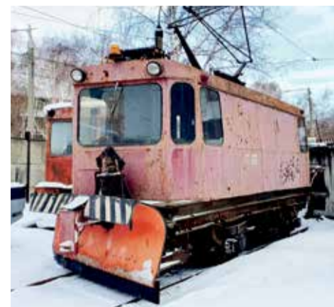
Этот спецвагон был выпущен в середине 1980-х годов и раньше был оборудован щеткой. Теперь на его «корме» — отвал. Трамвай уже минимум дважды отслужил свой срок, но благодаря высококлассным специалистам Иркутскгортранса все еще на ходу. А сегодня он усилиями рационализаторов предприятия получил новое оснащение и вновь выполняет свою функцию на отлично. «У нас уже приготовлена краска — хотим освежить вагон, но снегопады этой зимы никак не дают на это времени. Как только выдаться окно — трамвай изменит свой внешний вид», — говорят в депо
