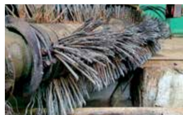
Спецвагон с гидropоворотной щеткой (навесное оборудование, угол наклона которого регулируется с помощью гидромеханики транспорта, на котором установлен агрегат. Такие щетки используются для уборки дорог, тротуаров от песка, мусора и снега. — Прим. ред.) очищает трамвайные пути не только от снега, но и от льдин и камней. И чтобы не нанести вред машинам и прохожим, эта техника задействуется только в ночное время. Днем такие вагоны почти всегда стоят на приколе
