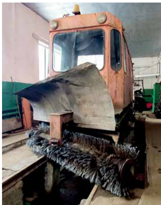
Спецвагон с гидropоворотной щеткой (навесное оборудование, угол наклона которого регулируется с помощью гидромеханики транспорта, на котором установлен агрегат. Такие щетки используются для уборки дорог, тротуаров от песка, мусора и снега. — Прим. ред.) очищает трамвайные пути не только от снега, но и от льдин и камней. И чтобы не нанести вред машинам и прохожим, эта техника задействуется только в ночное время. Днем такие вагоны почти всегда стоят на приколе
