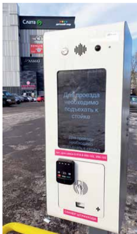
Так выглядят паркоматы торгового центра «Карамель» на въезд и выезд. В одном получаем персональный талон, во втором сканируем штрих-код с него для выезда. Оплатить парковку можно банковской картой или наличными в терминале на входе в торгово-развлекательный центр
