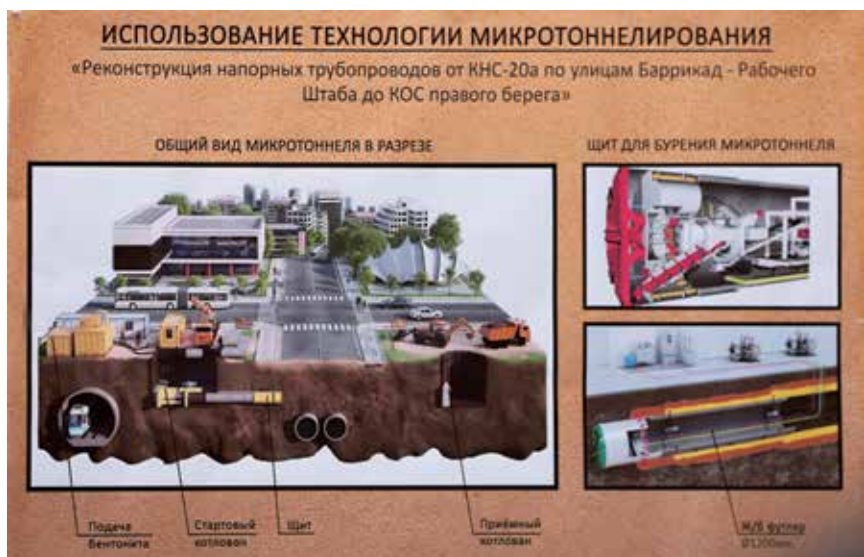
Микротоннелирование: новая технология в Иркутске. Ее применяют, например, при строительстве метрополитена. Бурение для прокладки трубопровода КНС идет на глубине в шесть метров. Здесь где-то насыпные, где-то галечные грунты, имеющие вкрапления бетона, дерева, металла, поэтому и был выбран микротоннель — уровень подземных вод высокий, и если эти работы выполнял открытым способом, то ни о каком строительстве теплового луча не могло быть и речи в течение полутора лет — до усадки грунта
