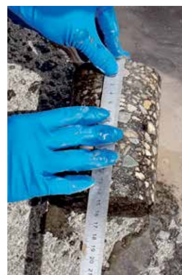
Кусок, выпиленный из дороги, на профессиональном языке называется «керн». Высота этого цилиндра (то есть толщина новой дороги на Кряжева) — ровно 14 сантиметров! Невооруженным глазом видно два слоя асфальта: верхний — 5 см, остальное — выравнивающий
