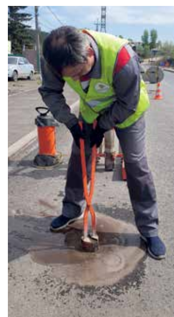
Асфальтобетонный керн вынимается из общей толщи дорожного покрытия с помощью специальных щипцов. Все три отверстия после забора проб дорожники заполняют тем же материалом
