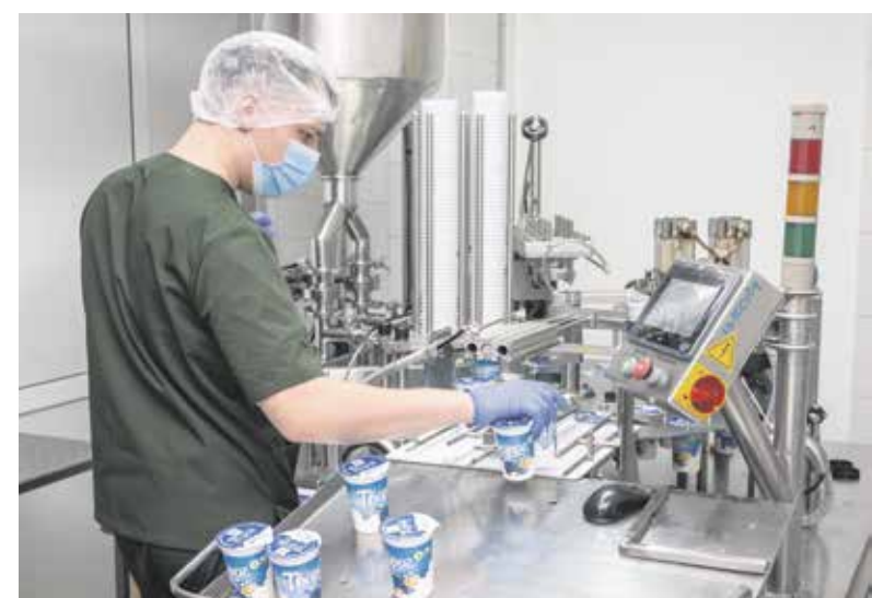
Фасовочным автоматом для упаковки творога управляет Максим Попов, инженер «Детской молочной кухни». Он наполняет емкость готовым продуктом, загружает стаканы, настраивает «даты» и следит за наличием в нем чернил. Все остальные действия выполняются автоматически и очень быстро, буквально за секунды
