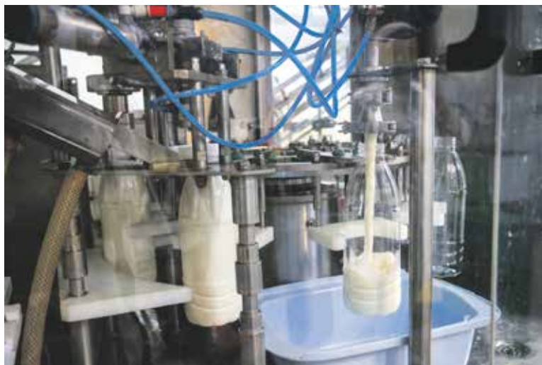
С помощью аппарата «Трибл» молоко разливают в бутылки разного объема. Сам процесс выглядит красиво и завораживающе. Как только емкость заполнена, автомат тут же накрывает ее крышкой и сам закручивает
